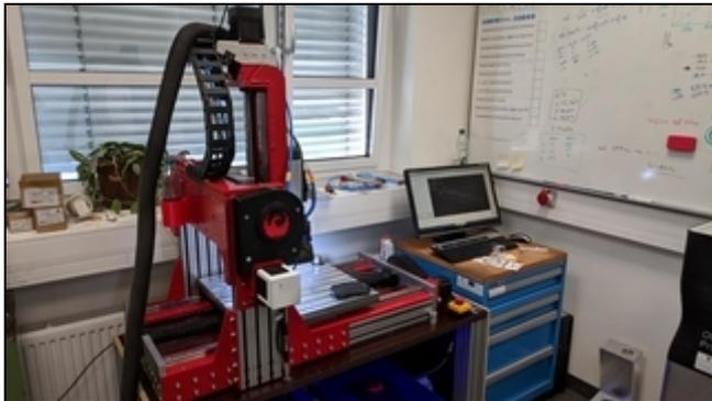
Bei "The Rising Phenix" handelt es sich um eine fixed Gantry CNC-Portalfräsmaschine
